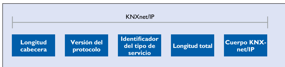
Imagen 16. Estructura de telegrama en KNXnet/IP.
