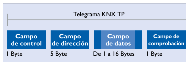
Imagen 7. Estructura de telegrama en KNX TP.
